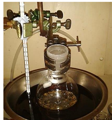
Abbildung 6: Rundkolben mit Rapssamen, Heptan und Rührfisch.
